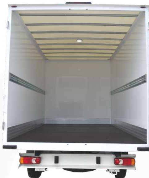
Caja Paquetera con panel sandwich 30mm
